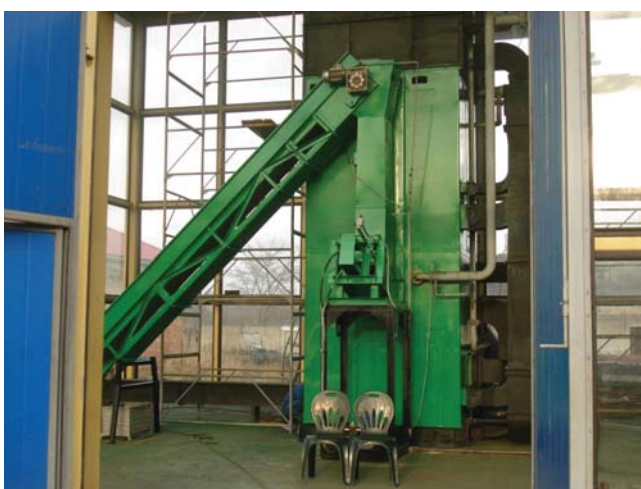
Рис. 1. Топочное устройство с системой многозонного воздушного дутья
